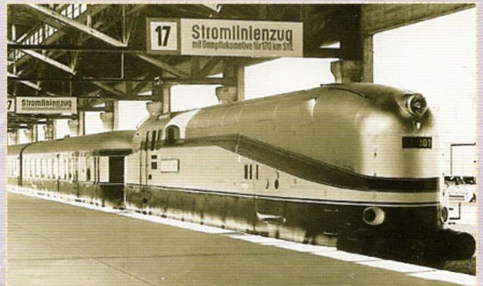
Im fahrplanmäßigen Einsatz ab Sommer 1936 schaffte der so genannte Henschel-Wegmann-Zug die 176 Kilometer lange Strecke zwischen Berlin und Dresden in 100 Minuten. Eine 1939 fertig gestellte ähnliche Lokomotive wurde nach dem Krieg von der DDR-Reichsbahn zur Schnellfahrlok der Baureihe 18 201 umgebaut. Sie ist bis heute erhalten und gilt als schnellste betriebsfähige Dampflokk der Welt.
