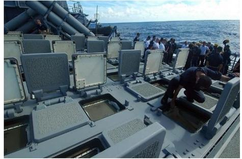
Senkrechtstartanlage MK-41 auf einem US-Kriegsschiff, Foto: US-Navy
